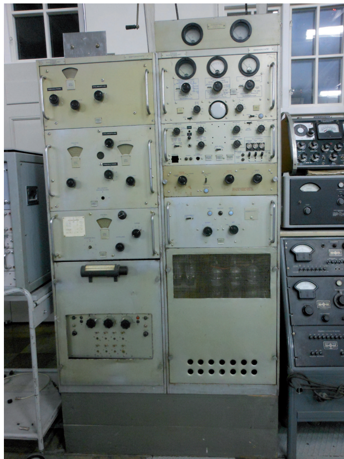
Sändare K2, Anropssignal: SDC...Svenska Radioaktiebolaget, typ AK – 142; 0,8 kW, 3-12 MHz, inköpt 1944
